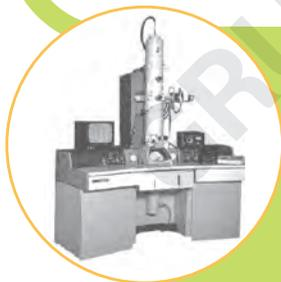
En el Siglo XX llegó el gran cambio con el microscopio electrónico, que sustituyó la luz por electrones; y las lentes por campos magnéticos. El primer microscopio electrónico lo construyó el físico canadiense James Hillier en 1937 y tenía la capacidad de ampliar las imágenes hasta 7000 veces.
